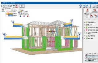
一般診断法や精密診断法の上部構造評点や耐力壁補強、柱金物補強箇所を3Dで可視化します。建物の耐震性能をより直感的に認識できます。
