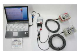
建物の常時微動を計測し、計測結果より求められた固有振動数をもとに、耐震性を客観的に評価することが可能です。
